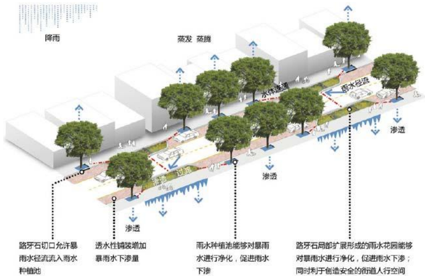
图 6.4- 3 道路低影响开发设施的选择与应用示意图
