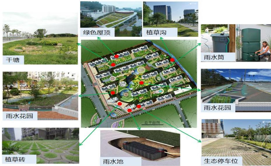
图 5.4- 2 居住用地雨水收集利用示意图
