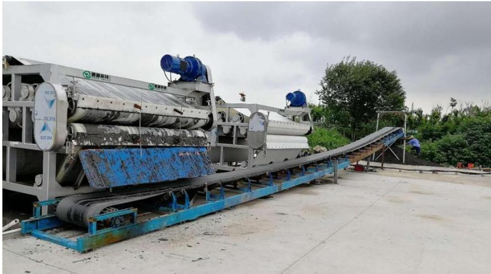
图 5.2- 4 污泥脱水干化机现场
