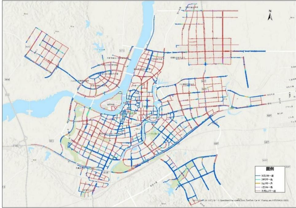
图 3.1- 10 主城区管网排水能力评估图
