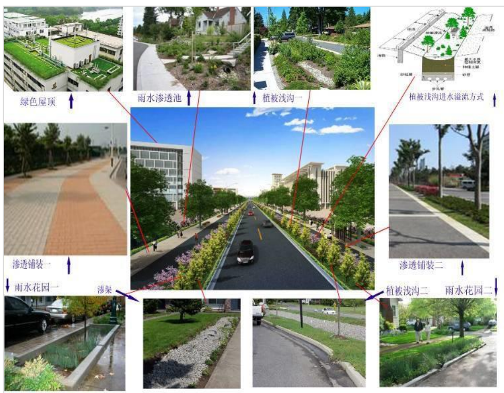
图 5.4- 4 工业和物流仓储用地雨水收集利用示意图
