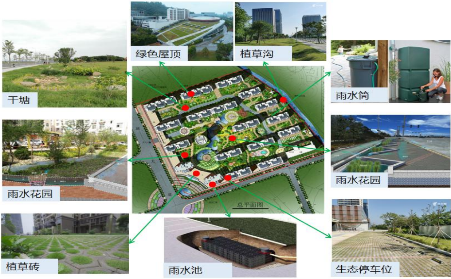
图 5.4- 2 居住用地雨水收集利用示意图
