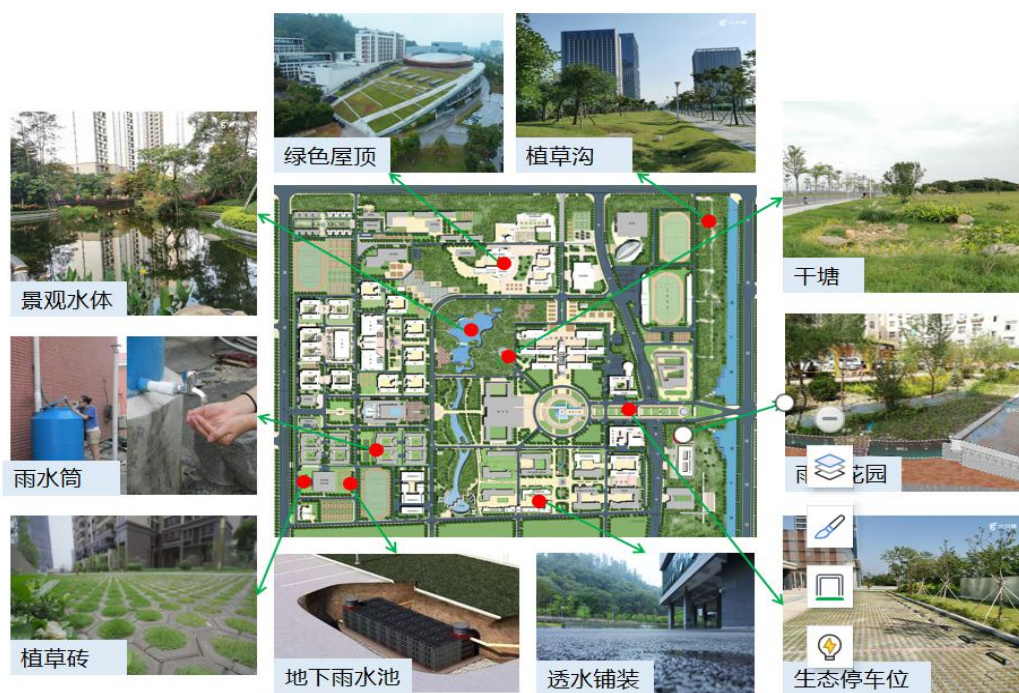
图 5.4- 3 公共设施和商业服务用地雨水收集利用示意图
