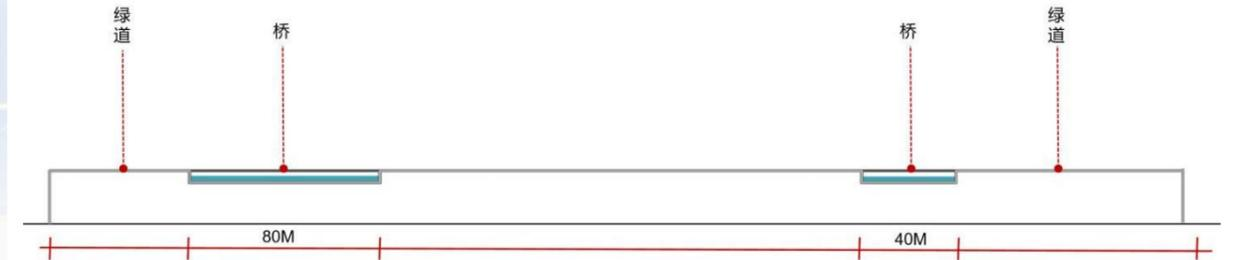
图 6-19-1 开口堤（溢流堰）断面形式图
