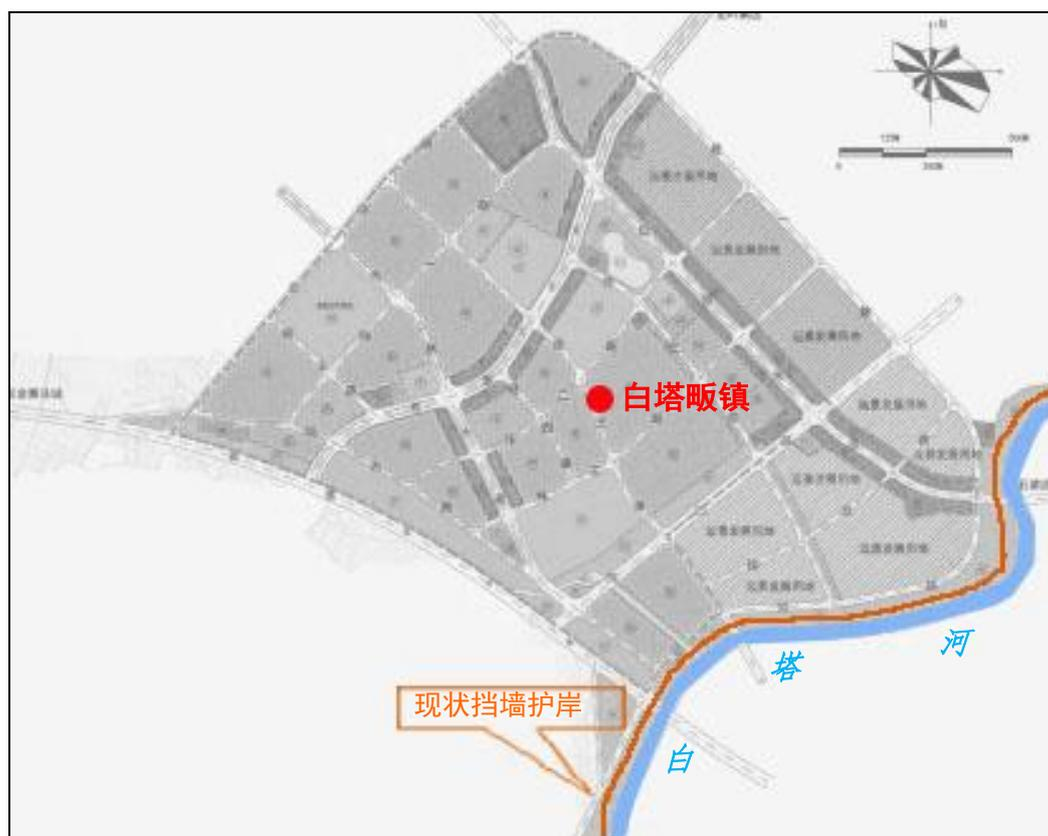
图5.6-5 白塔畈镇区防洪工程布局图
