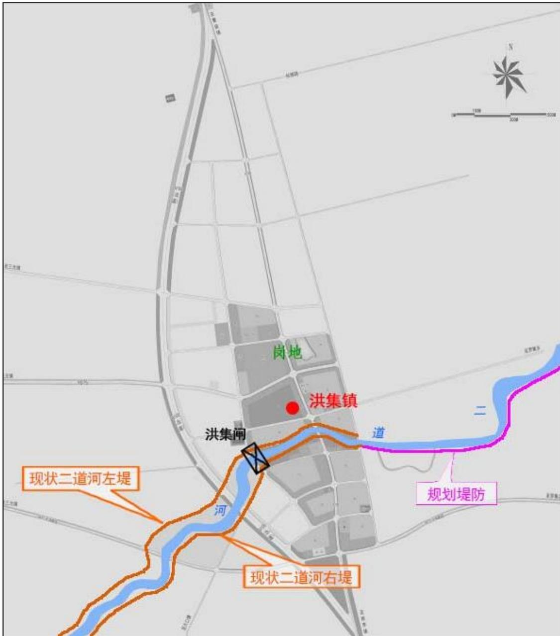
图5.6-4 洪集镇区防洪工程布局图
