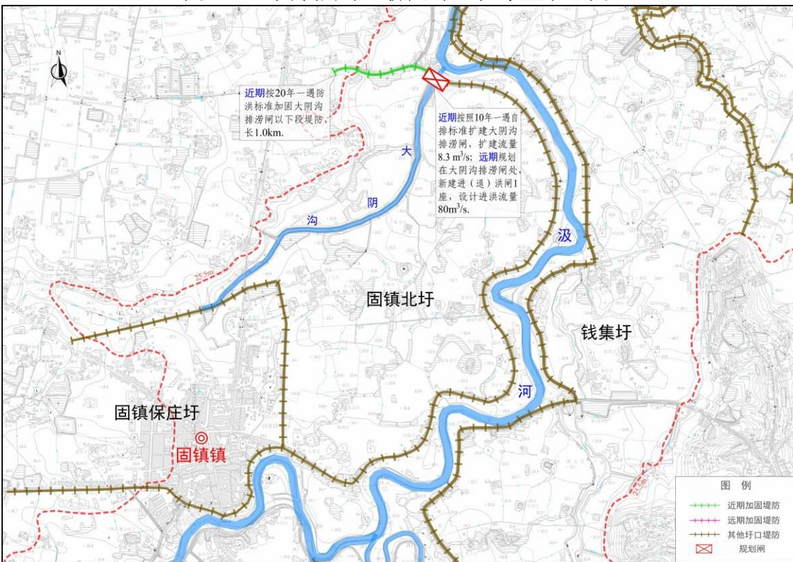
图5.4-5 固镇北圩工程布置示意图
