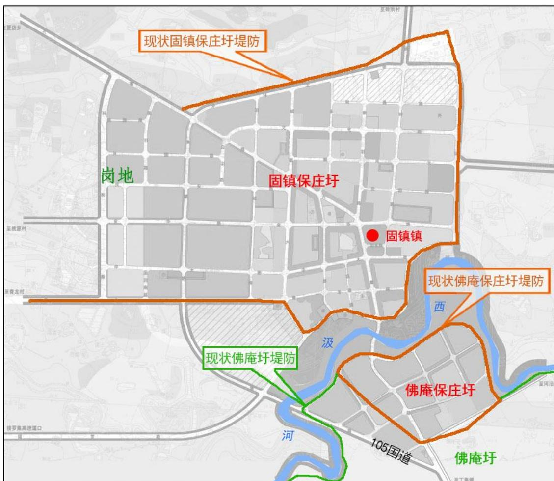
图5.6-1 固镇镇区防洪工程布局图
