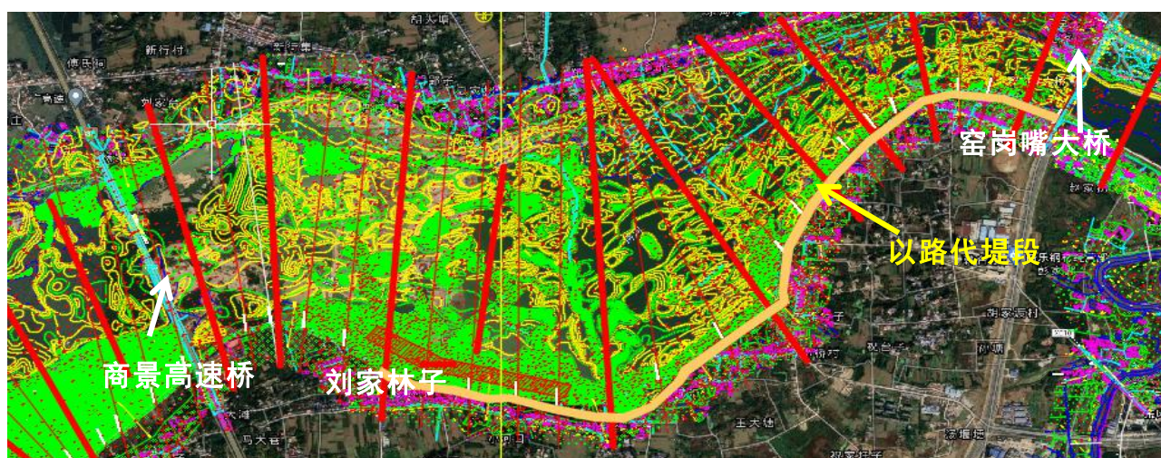
图 13.1-1 淠河六安城区段刘家林子~窑岗嘴大桥段右岸以路代堤
