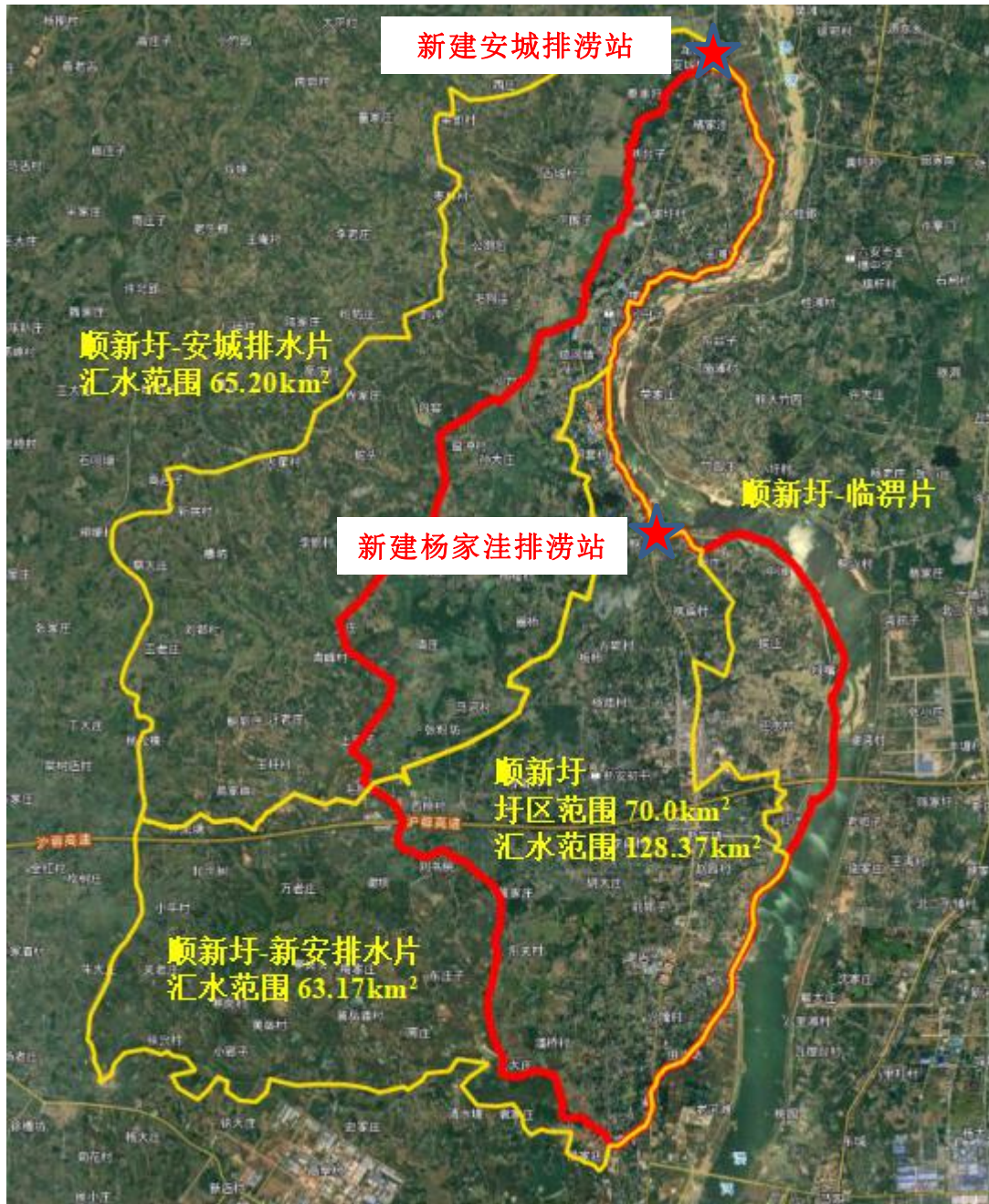
图 5.5-4 (d) 顺新圩工程布置
